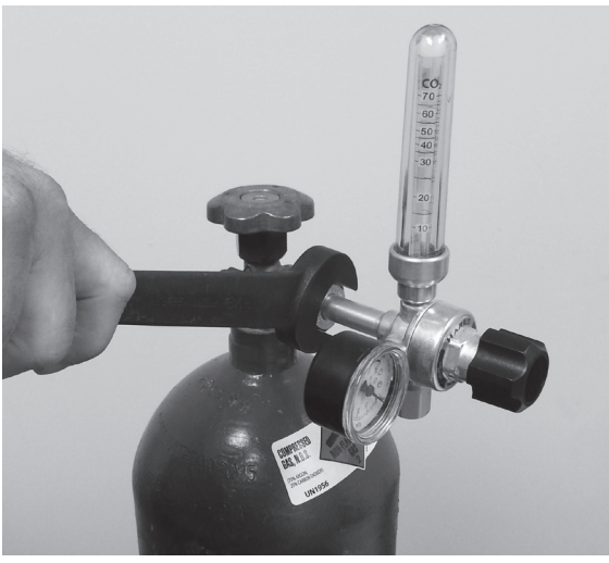
Figure 2. Fixation du débitmètre/détendeur
