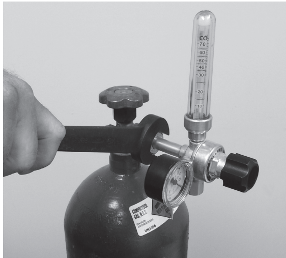
Figura 2. Cómo Conectar el Flujómetro/Regulador
