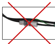
Mauvaise position du pot à condensat
