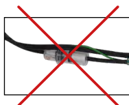
Posição incorreta da câmara de condensados
