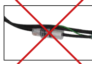
Posición incorrecta del depósito de condensados
